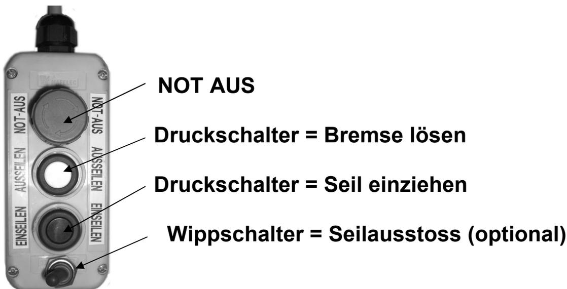
Zum Seil ausziehen, ohne Seilausstoss, ist der weiße Knopf ca. 3-4 sek. lang zu drücken, um die Bremse vollständig zu öffnen. Kurzes Antippen des weißen Knopfes öffnet die Bremse langsam. Kurzes Antippen des schwarzen Knopfes (Einseilen) schließt die Bremse wieder. Zum Einziehen des Zugseiles ist der schwarze Knopf zu drücken. Wird dieser los gelassen, bleibt die Seiltrommel stehen und bremst automatisch ein (=Totmannschaltung).
